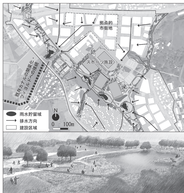
図-2 マドラ・レヴヘイム地区中央部雨水管理模式図（上）と貯留域（下）。拠点とスポーツ施設は、緑陰広場を抜け、貯留域の親水デッキでGSと連結する。
