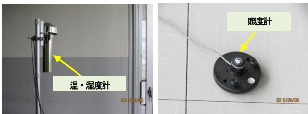
写真-4 G1, G2棟教室内に設置した計測器
