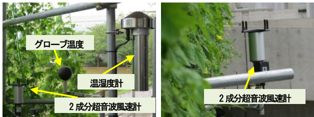
カーテン裏側 カーテン表側 写真-3 G2棟の計測器設置状況
